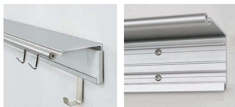
端のネジキャップをはずしてフックを付けます。フックはスライドして動きます。
